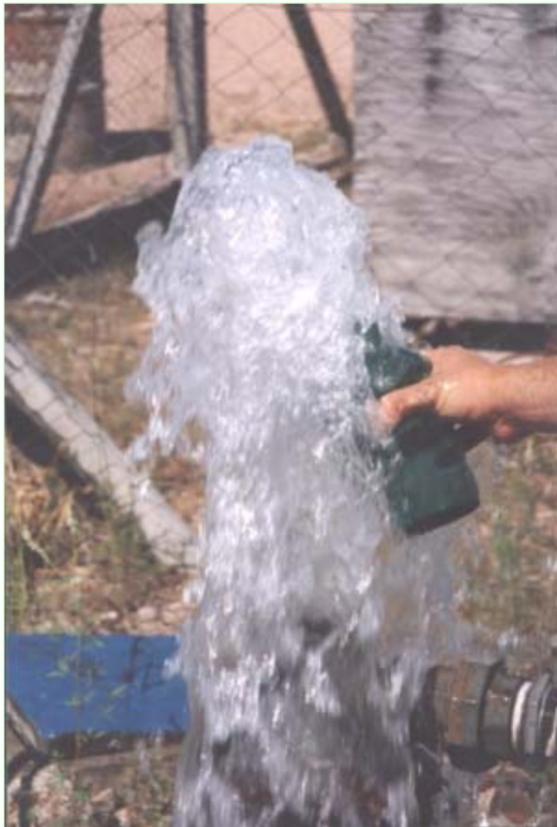
Muestreo de agua subterránea. Perforación en Areniscas Cretácicas. Fray Bentos, Río Negro, Uruguay
